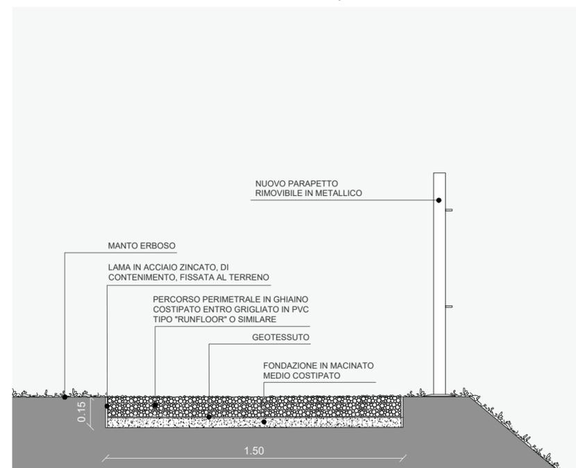
**PROSPETTO PERCORSO DI VISITA CON PARAPETTO RIMOVIBILE, scala 1:20**
