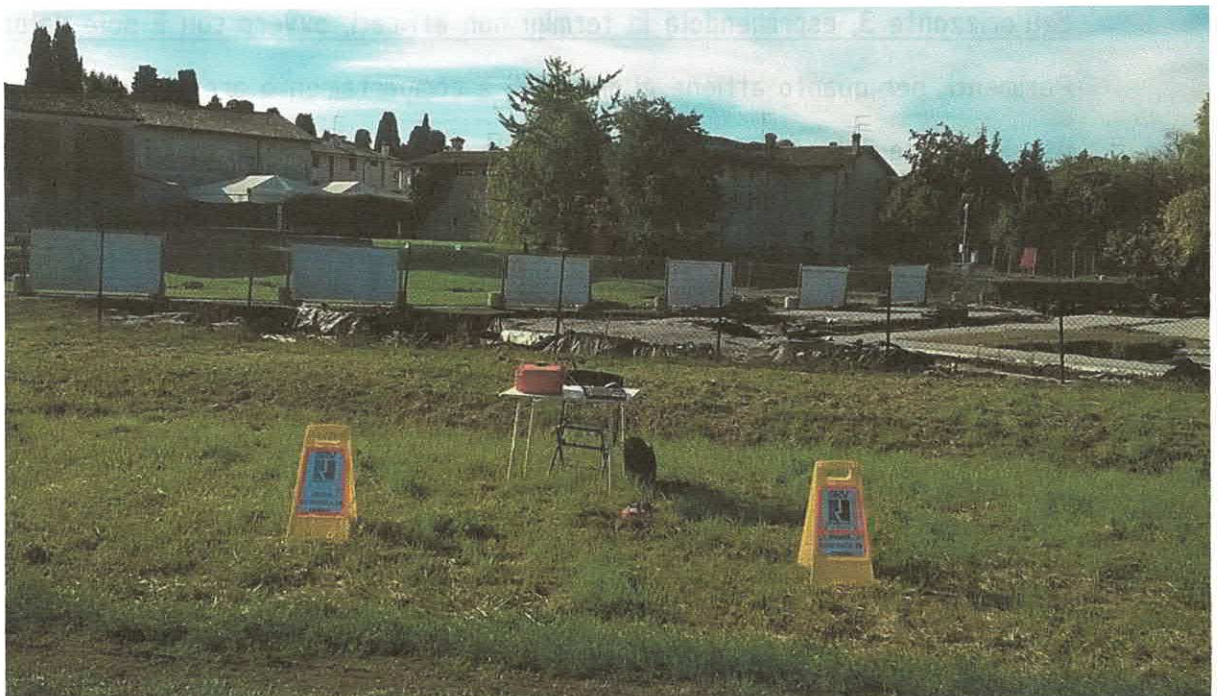
Esecuzione indagine sismica MASW e HVSR
