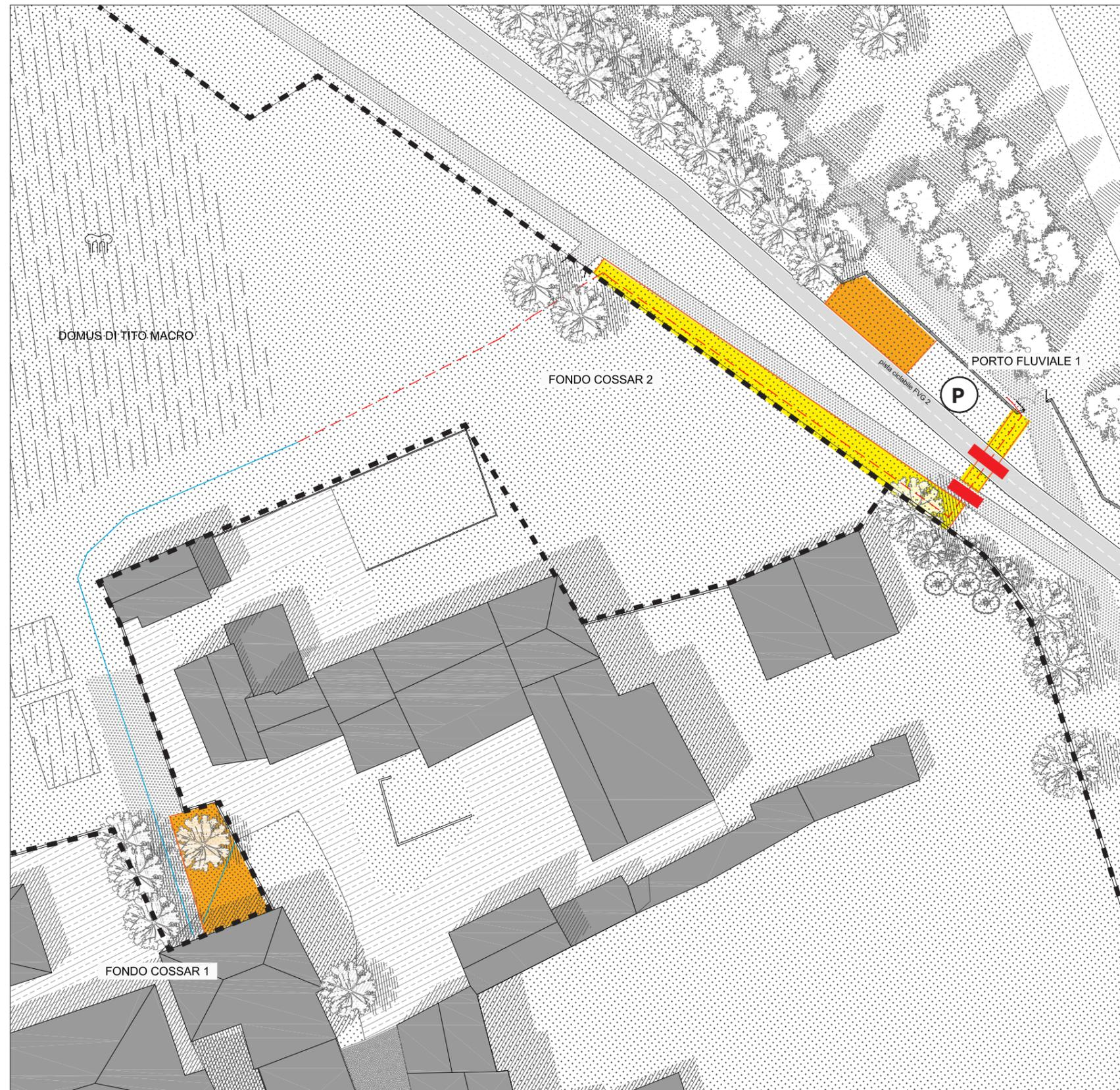
Verrà adibita un'area in prossimità dell'accesso al Porto fluviale per il deposito di materiali. L'area verrà recintata e a fianco sarà possibile posizionare i mezzi.
