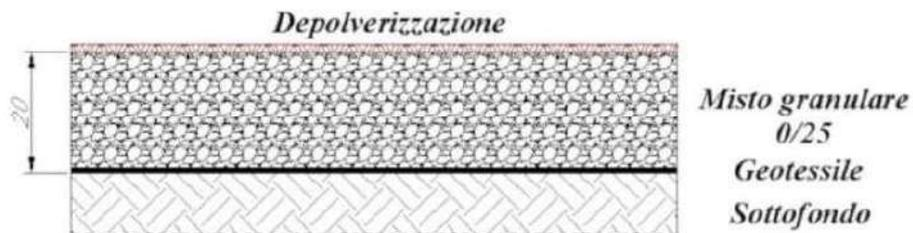
Figura 2 - Ipotesi di pavimentazione con strato con strato superficiale costituito dal trattamento di depolverizzazione
