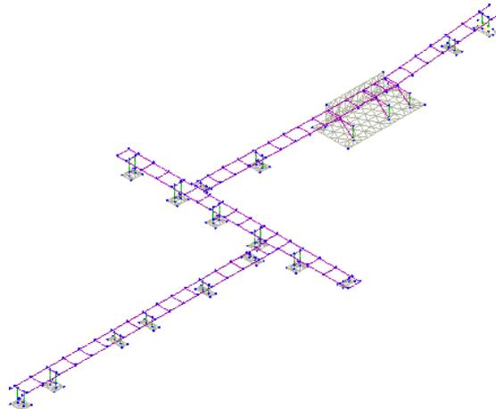
Dalle illustrazioni precedenti si evince come le aste, sia travi che pilastri, siano schematizzate con un tratto flessibile centrale e da due tratti (braccetti) rigidi alle estremità. I nodi vengono posizionati sull'asse verticale
