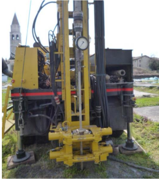
Esecuzione prova CPT in foro
